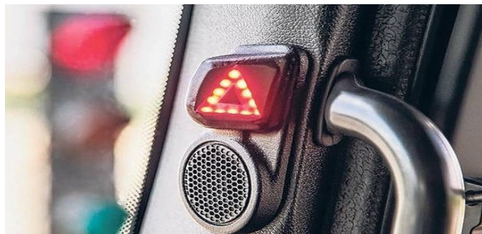
Abbiege-Assistenzsystem mit visueller und akustischer Warnfunktion.
